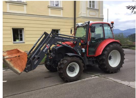
480/70R30 - 420/65R20, 16/16 Lastschaltung, Kabinenfederung, Radio, LED- Rundumleuchte links und rechts, Zusatzhubzylinder, Fronthubwerk Hub/Druck, 4 Leitungen vorne, 7-polige Steckdose vorne, Anhängerbremsventil, 3 dws Steuergeräte mit Einhebel, Mikroschalter, Leckölsammelbehälter, TBS-Konsole, Synchrolock, Hinterachsabstützung, Pom-L70 Frontlader ohne Schaufel (Standort Klagenfurt)
