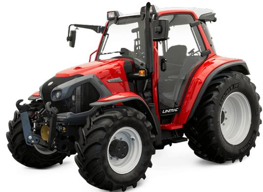
Z58, Bereifung: 480/70-R30 Mitas HC70 - 420/65-R20 Mitas AC 65, Kabinenfederung mechanisch, LINDNER-Hinterachslenkung, Komfort-Freisichtkabine mit Klimaanlage, Lindner FZW+FH, verstärkt, 2.500kp, Abstützung, EFH mit Geräteentlastung für FH, 4-Radbremse, Anhängerbremsventil, Sicherheitssperre, 4x EHS dws Steuergeräte, Frontladerkonsole TOP BLOCK + 4 Leitungen, Synchrolock-Schlauchkuppler Unterteil mit E-Anschluss 3 polig
