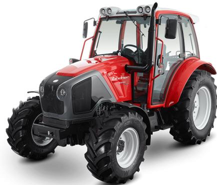
Z58, Bereifung 480/65-R28 Mitas AC 65 u. 365/70-R18 Mitas AC 70G, FZW + FH, 2 Leitungen nach vorne, dws + dws + dws Stg., 6 Kipperleitungen + 1 Rücklauf, Kennzeichenhalterung;
