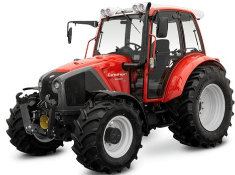
Z57, Bereifung 420/85-R30 Mitas AC85 und 375/70-R20 Mitas AC70G, 16/16-Gang-ZF-Steyr-Getriebe mit Zweifach-Lastschaltung, Kabinefederung mechanisch, Lindner Frontzapfwelle und Fronthydraulik, 2 Leitungen nach vorne, 4-Radbremse, dws + dws + dws Steuergerät (inkl. EH), 6 Kipperleitungen + 1 Rücklauf, Kennzeichenhalterung
