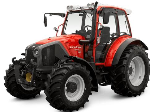
Z58, Bereifung 540/65-R34 Mitas AC65 und 440/65-R24 Mitas AC 65, Klimaanlage in der Dachschale integriert, Kabinenfederung mechanisch, Radio mit CD-Player, Lindner FZW und FH verstärkt, EFH mit Geräteentlastung für FH, 2 Leitungen nach vorne, dws + dws + dws Steuergerät (inkl. EH), Multicontroller (9 Taster) Ausf. Mikrosch, 6 Kipperleitungen + 1 Rücklauf, Kennzeichenhalterung
