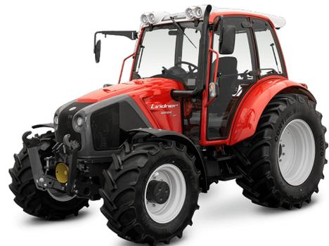
Z60, Bereifung 480/70R-30 Mitas HC 70 u. 405/70-R20 Mitas AC 70G, ebene Plattform mit Kabinefederung mechanisch, Lindner FZW + FH verstärkt, Hubarme mit Schnellkuppler KAT2, 2 Leitungen nach vorne, Anhängerbremssventil, dws + dws + dws Stg. 6 Kipperleitungen + 1 Rücklauf, Kennzeichenhalterung einzeilig;
