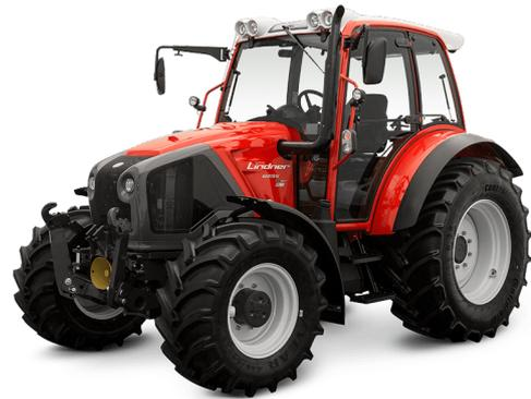
Z58, Bereifung 540/65-R34 Mitas AC 65 u. 440/65-R24 Mitas AC 65, Kabinenfederung mechanisch, ausziehbare Seitenspiegel, Radio mit CD u. Bluetooth, Unterlenker Kat 2, Ackerschiene hinten, Lindner FH verstärkt, 3x dws inkl. EH., 6 KL + 1 RL, Lindner Verbands-Set, Aufkleber 70 Jahre Lindner
